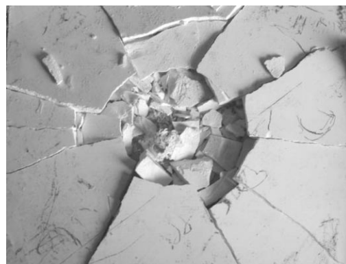
Рис. 9. Разрушение керамической пластины под действием пули.
