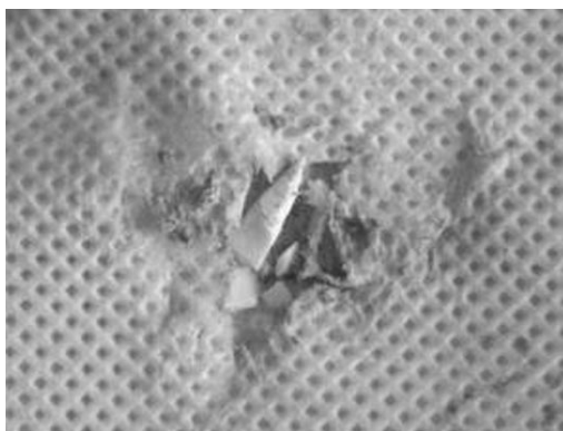
Рис. 8. Тыльная поверхность частично разрушенного тканевого пакета панели, состоящей из керамических компонентов в форме пластин.
