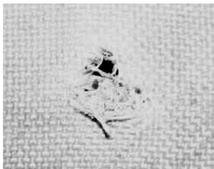
Рис. 5. Входное отверстие пули на наружной поверхности панели с тканевым покрытием.
